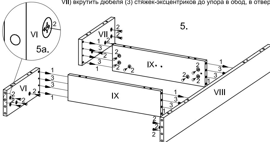
Присоединить к стенке задней (VIII) стенки центральные (IX) и зафиксировать, поворачивая стяжки-эксцентрики (2) в стенках центральных (IX) отверткой по часовой стрелке. Присоединить стенки передние (VI и VII) к стенкам центральным (IX) и закрепить, поворачивая стяжки-эксцентрики (2) в стенках центральных (IX) отверткой по часовой стрелке (рис. 5).
