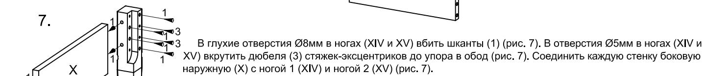
В глухие отверстия Ø8мм в ногах (XIV и XV) вбить шканты (1) (рис. 7). В отверстия Ø5мм в ногах (XIV и XV) вкрутить дюбеля (3) стяжек-эксцентриков до упора в обод (рис. 7). Соединить каждую стенку боковую наружную (X) с ногой 1 (XIV) и ногой 2 (XV) (рис. 7).
