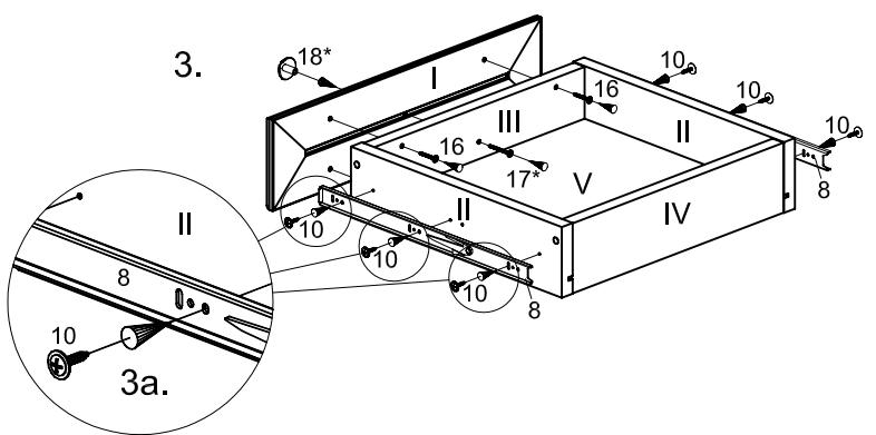
Установить узкие планки направляющих (8) на боковые стенки ящика (II) и закрепить саморезами (10) через вертикальные пазы в направляющих (8) в заранее просверленные отверстия в боковых стенках ящика (II) (рис. 3 и За). Перед окончательной фиксацией выровнять направляющие (8) параллельно нижней кромке ящика, так, чтобы саморез (10) находился примерно по середине вертикального паза на направляющих (8).
